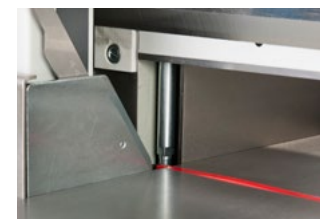
Schneidleisten auswerfer erleichtert und verkürzt den Schneidleistenwechsel
